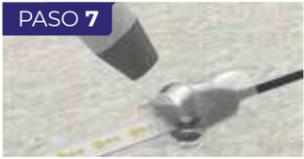
Se recorre el Thermofit (que previamente habíamos colocado) hasta centrar entre la manguera y la clavija y se sella con pistola de calor, (o en su defecto, con un encendedor extremando precauciones).
