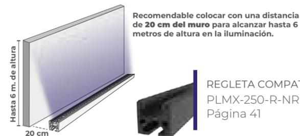
Recomendable colocar con una distancia de 20 cm del muro para alcanzar hasta 6 metros de altura en la iluminación.
