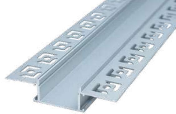
El diseño de este perfil se empotra totalmente a la superficie sin dejar ningún tipo de bisel, con lo cuál logra fusionar la iluminación con el espacio. Debido a que el perfil cuenta con un interior muy amplio que le permite distribuir la luz de manera uniforme, el resultado final es una excelente iluminación que parece emerger de muros y techos.
