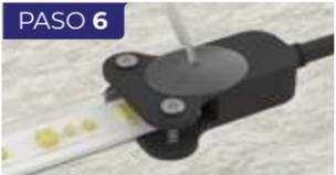
Se sella todo alrededor de la clavija con silicón, esparciendo con el dedo. (Incluyendo la clavija, la unión y parte de la manguera).
