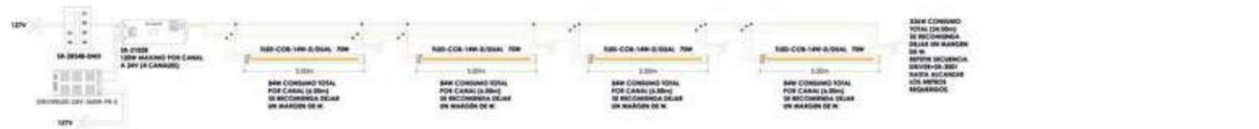
Ejemplo de crecimiento max. en paralelo con una tira LED TLED-COB-14W-D/DUAL+DRIVERLED-24V-120W-FR-5+SR-2102B+SR-2834B-DMX+DRIVERLED-24V-340W-FR-5+SR-3001 la capacidad del controlador es el alcance en cuanto a metros de tira LED.
